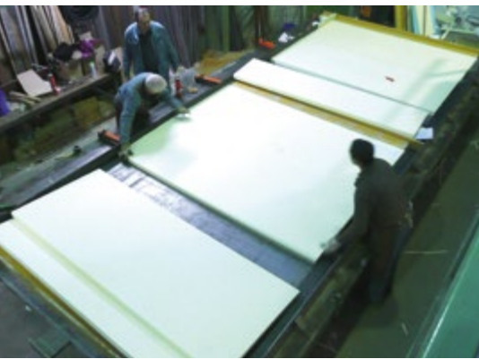
Einlegen der Dämmung im Werk
