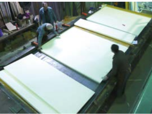
Einlegen der Dämmung im Werk
