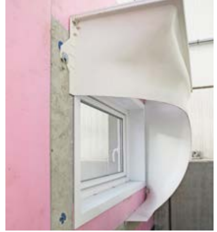
KNECHT – Sonderlösung: Fenster, Abdeckrahmen und druckwasserdichter Lichtschacht bilden eine Einheit – seitliches Verputzen der Außenwand im Lichtschacht entfällt.
